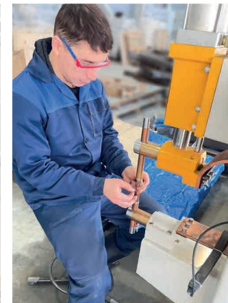
Участок контактной сварки
