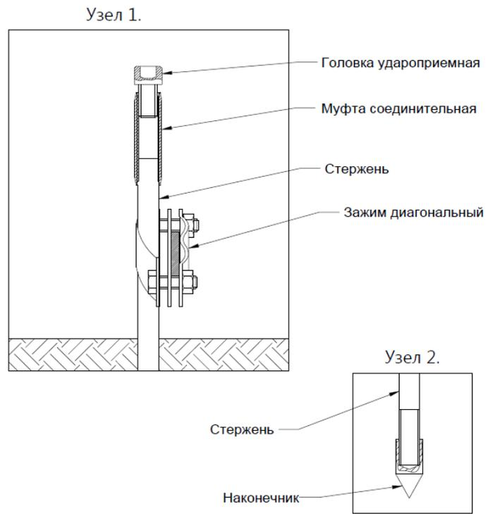
**Рис. 9. Схема модульно-штыревого заземлителя.**
