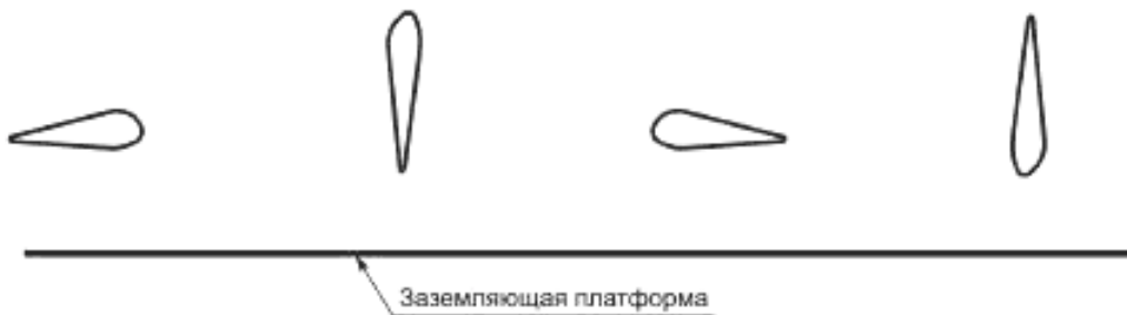
Рисунок D.2 — Возможные положения лопасти для испытаний на приложение начального лидера по схеме А
